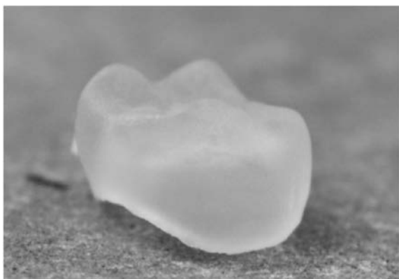
写真3 ミリング直後のSUPRINTHI。透過性が高いのでマージンや内冠の適合状態を直視で確認できる。
