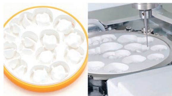
図4 ジルコニアディスクとその切削加工 (クラレノリタケデンタル株式会社資料引用改変)。
