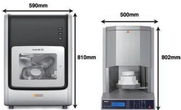
図5 主にラボサイドで運用される大型ミリングマシンとジルコニア用シンタリングファーンエス、大型ミリングマシンにはこの他にコンプレッサーも必須となる (Dentsply Sirona 社資料引用改変)。
