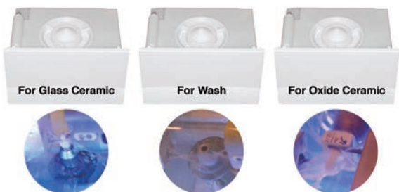
図24 湿式加工ではガラスセラミック用、洗浄用、ジルコニア用、と3つのタンクが必須である。
