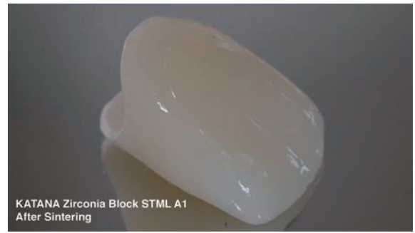
図19 シンタリングとグレージングが終了したY-PSZ (KATANAジルコニアブロックSTML) クラウン。滑らかなグラデーションが観察できる。
