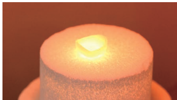
図37 シンタリングが終了、このまま除冷を行う。急速冷却は禁忌である。
