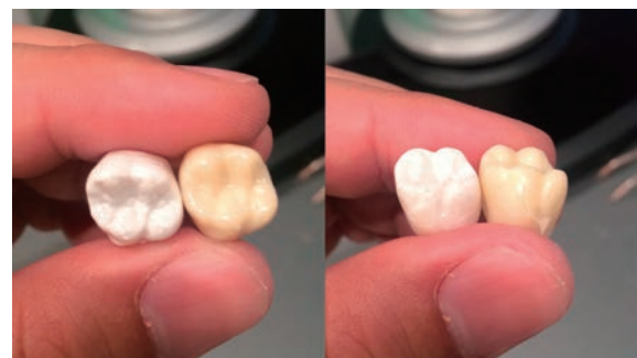
図27 左は意図的にグリーンボディの状態にシリカ汚染を行いシンタリングしたクラウン。右は通常の手順でシンタリングしたクラウン。ともに inCoris TZI-C A3 を使用しているが違いは明らかである。
