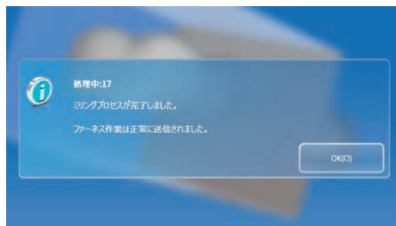
図28 セレックススピードファイアには加工したマテリアルによって自動的に焼成プログラムがインストールされる。
