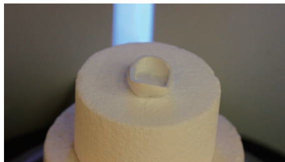
図36 焼成台に直接クラウンを逆さに置き、シンタリングをスタートさせる。
