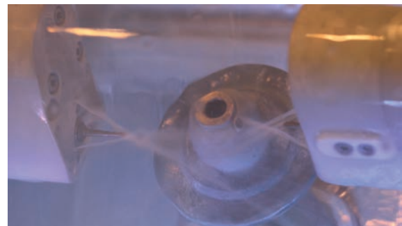
図26 内部洗浄の様子。ガラスセラミック用タンクを洗浄用水タンクに交換して行う。
