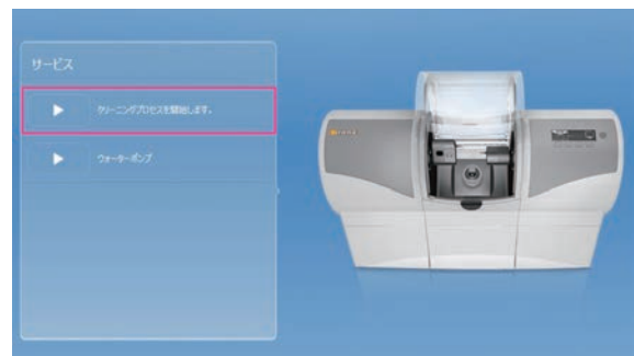
図25 セレックソフトウェア上部タブからコンフィグレーション→デバイス→ミリングマシンアイコン→サービスと進み、クリーニングプロセスの再生ボタンをクリックすると洗浄プログラムが始まる。
