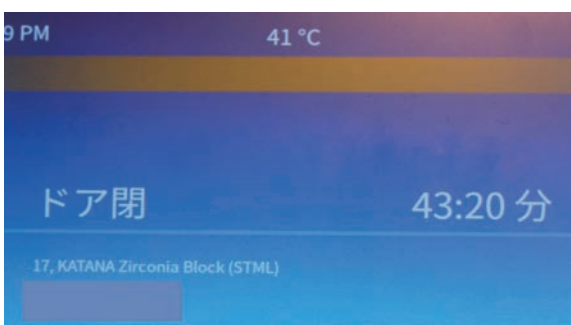
図35 シンタリングタイムは乾燥工程を合わせて約45分。
