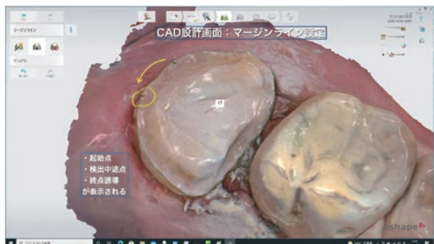
写真36 マグネットツールが効いておりマージンはAIが初期提案してくれる。マージンラインがシャープでない場合や、水分の影響を受けていると初期提案は行われぬ。
