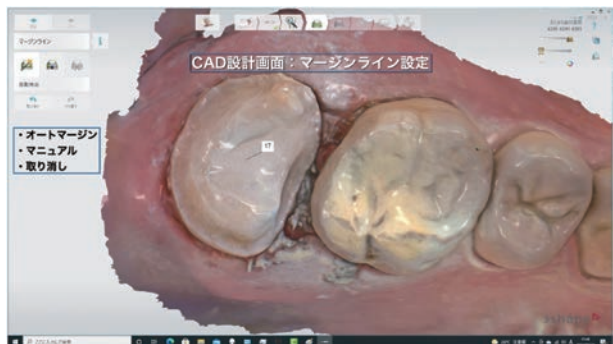
写真34 マージンラインの設定。マージンラインの設定から画像の解像度が引き上げられ判別が行いやすくなる。
