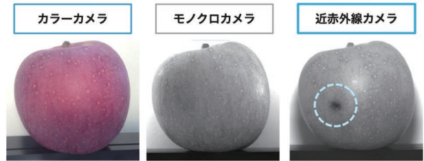
写真12 近赤外線はりんご蜜を調べたり、体脂肪計、魚の飽和脂肪酸密度などを計測するのに使用される。最近では人工衛星『はやぶさ』が小惑星の探査に使用したことで有名である。
