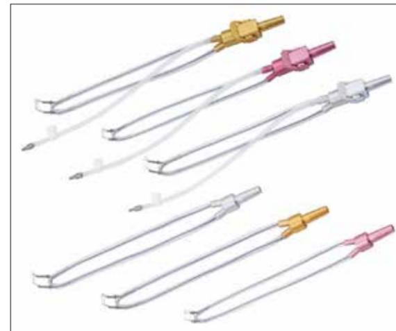
図 4 C-ZOO α (アプト)。ZOO と排唾管を駆使することでラバーダム防湿と同等の口腔内湿度下での治療が行えるため、CAD/CAM 治療の質が飛躍的に向上する。バキュームコネクターのコントローラーで吸引力を無段階に調節ことができ、治療部位への唾液の付着を防ぐことができる。また付属するバネ部のコイルスプリングの高さが 3 段階あり、開口し続ける患者の苦痛を軽減することができる。
