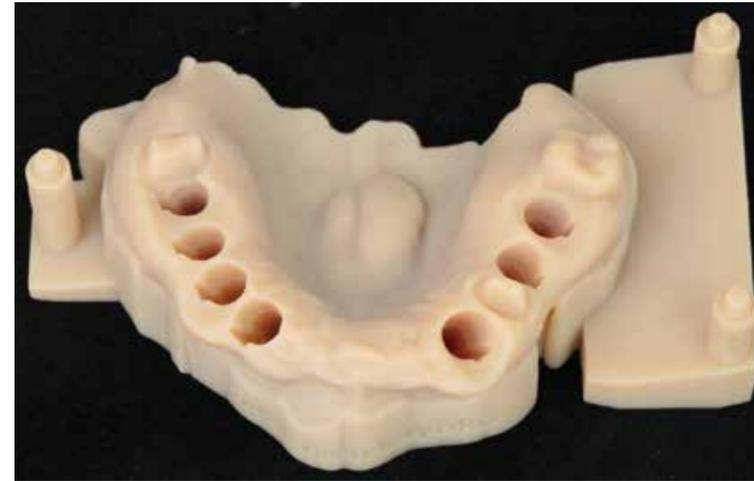
図1 インクジェット方式プリンタで造形した作業用模型。
